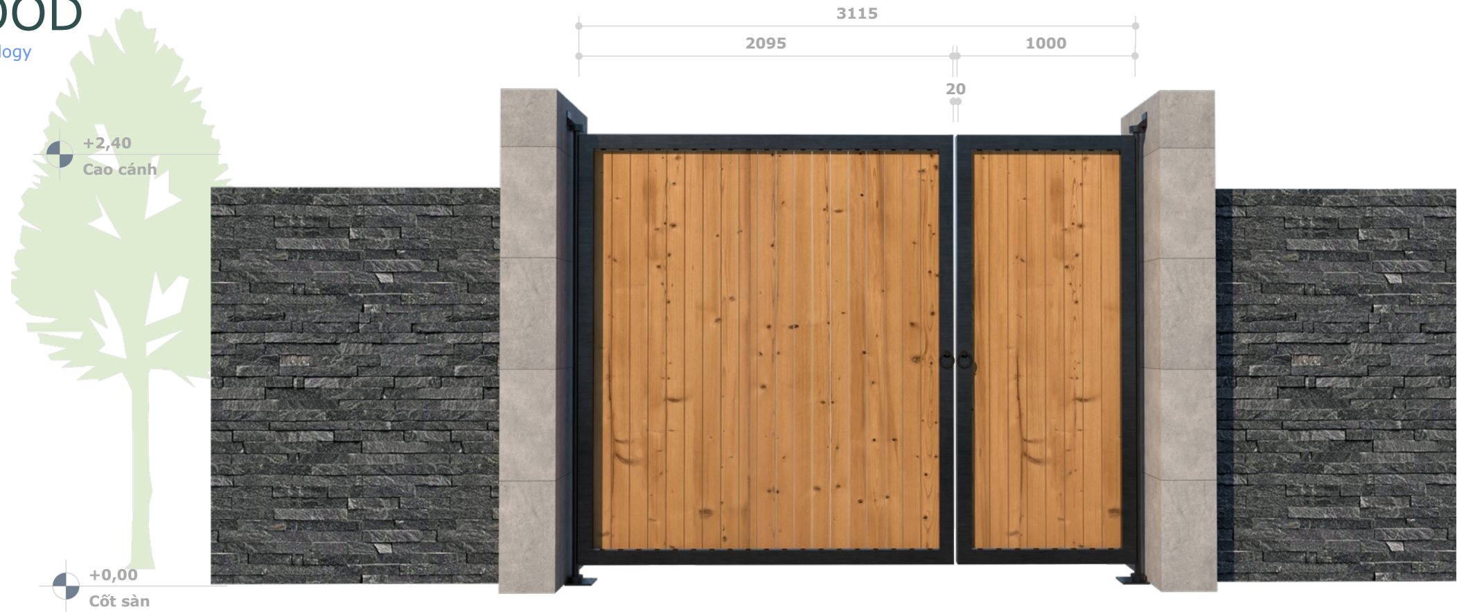
Cảnh của mở tự động với hệ quay âm sàn
